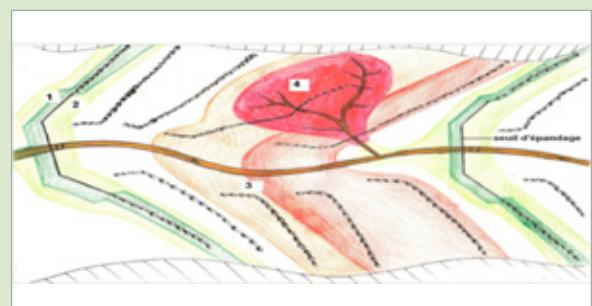
Illustration 6: Les surfaces situées au-dessus et au-dessous des seuils sont bien protégées (1, 2), le risque se renforce au fur et à mesure que la distance avec le seuil amont augmente (3) et des ravins d'érosion peuvent se former (4) Source : Bender, 2005, p. 24
