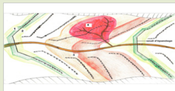
Abbildung 6: Ober- und unterhalb der Schwellen sind Flächen gut geschützt (1, 2), mit zunehmendem Abstand von der oberen Schwelle nimmt das Risiko zu (3) und Erosionsgräben können sich bilden (4). Quelle: Bender, 2005, S. 24
