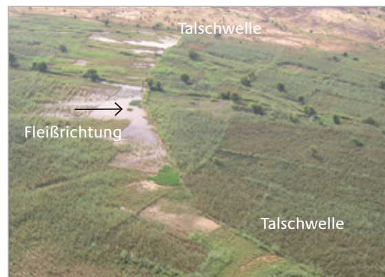
Abbildung 12: Das Wasser wird über die ganze Schwellenbreite verteilt, wodurch die Infiltration oben und unten zunimmt. Dadurch wird eine Bewirtschaftung (hier Sorgho und etwas Reis) über die ganze Breite der Talsohle und oberund unterhalb der Talschwelle möglich. Quelle: Bender (2011)
