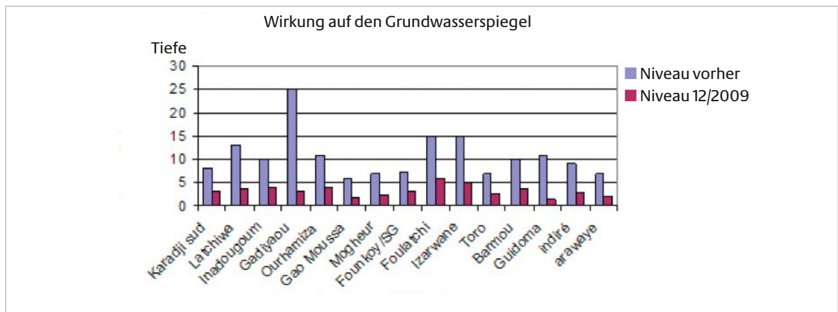
Abbildung 11: Anstieg des Grundwasserspiegels in rehabilitierten Tälern in Niger. Quelle: Sulser, S. 9 nach Betifor (2010)
