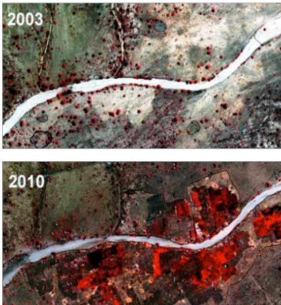
Abbildung 14: Gemüseanbauflächen (in rot) im Ouadi Chock (Tschad) vor dem Bau von Talschwellen (2003) und nach dem Bau (2010). Quelle: BCIE (2011)
