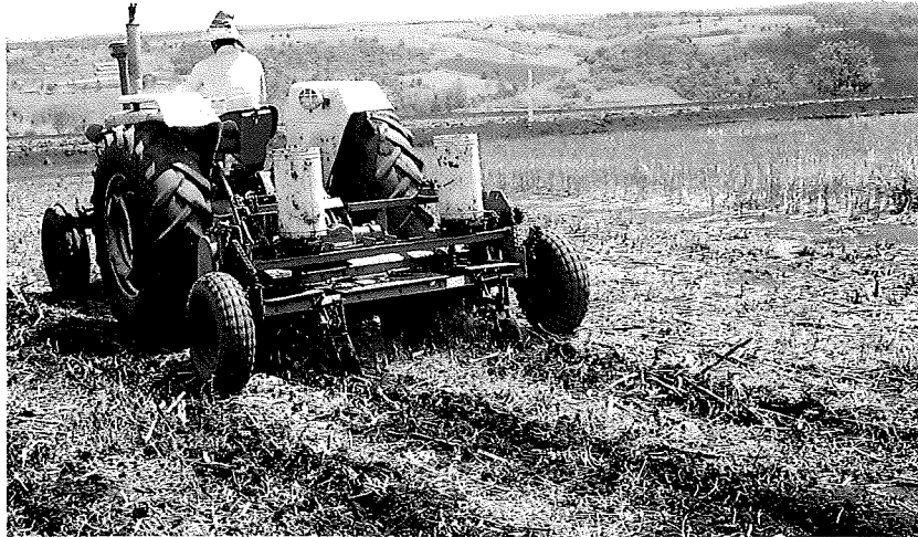
Abb. 9.4: Eine alte Fräse wurde kostengünstig in eine zweireihige Mais-Direktsaatmaschine umgewandelt. Zugkraftbedarf 35 bis 40 PS. (Photo: R. Derpsch)
