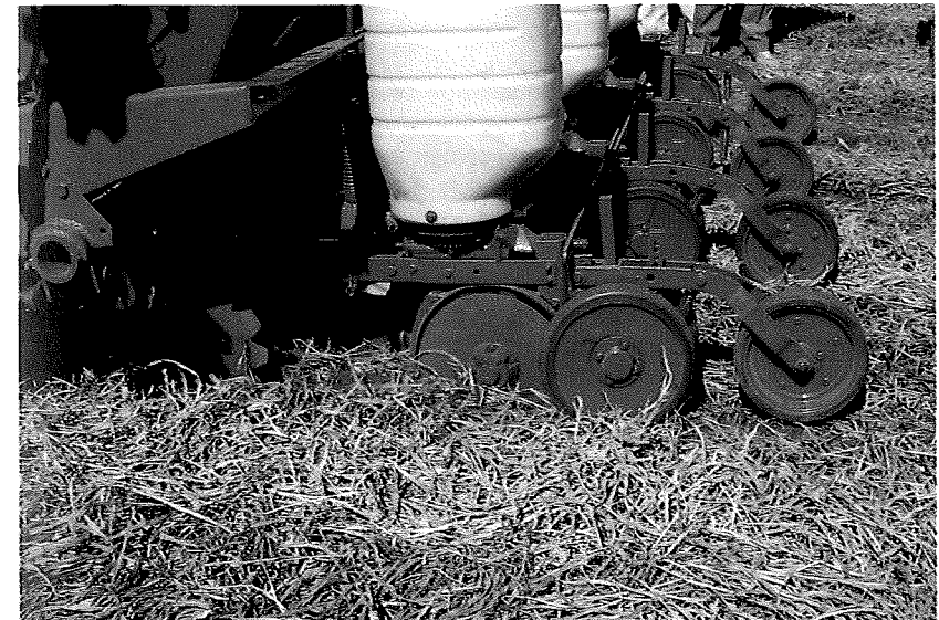
Abb. 9.3: Hier sorgen ein glattes, gezahntes Scheibensech für das Durchschneiden der Strohsschicht und ein Doppelschar für die Saatgutablage, gefolgt von Tiefenbegrenzungsrädern und Druckrädern.
