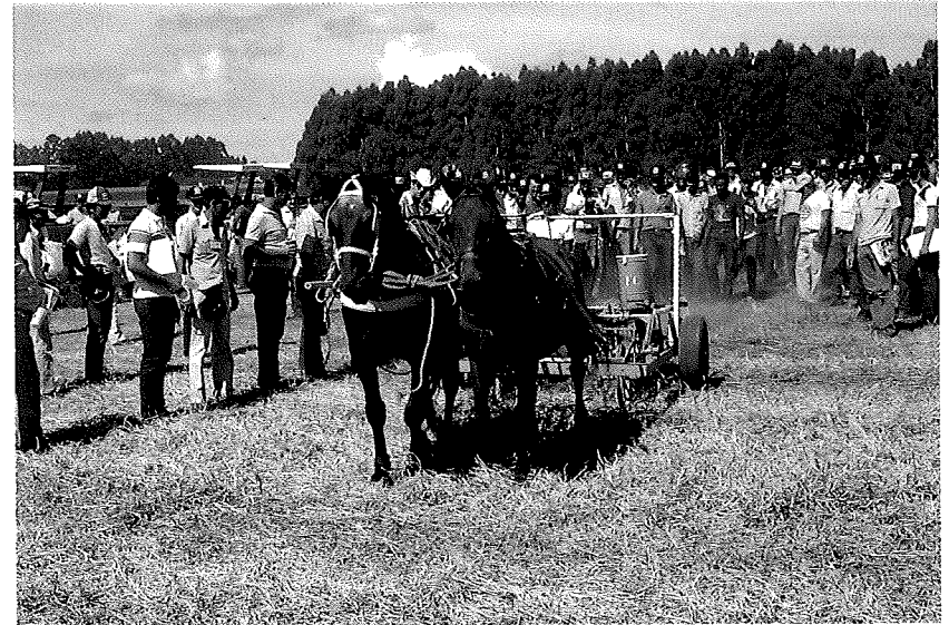
Abb. 9.7: Demonstration einer in Paraná entwickelten Direktsaatmaschine für tierische Anspannung. (Photo: R. Derpsch)
