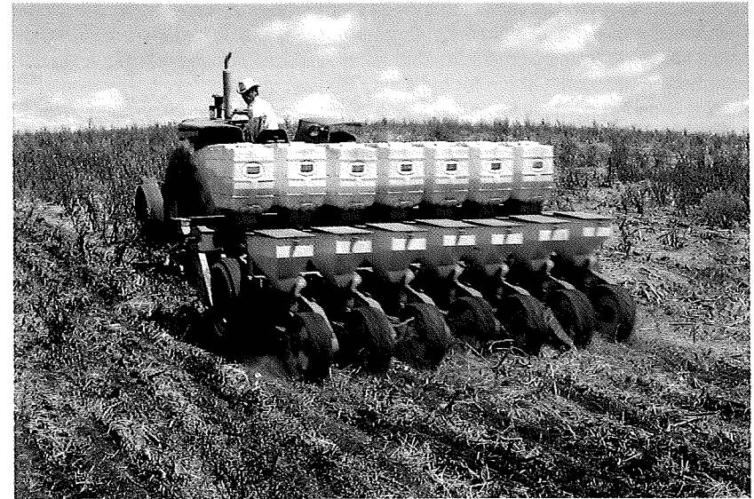
Abb. 9.2: Direktsaat von Sojabohnen. Durch Hochhängen des 2., 4. und 6. Scharns kann diese Maschine schnell für die Maisaussaat umgerüstet werden.
