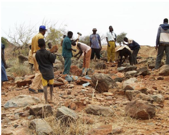
Préparation d'une carrière pour l'extratction des moellons
