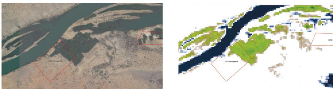
Un exemple d'un polygone mal placé, le PIV de Soungalore. Les polygones sont basés sur les données GPS prises sur le terrain. Il existe néanmoins un grand nombre de PIV ayant un polygone qui ne correspond pas du tout avec la réalité de l'image Landsat.
