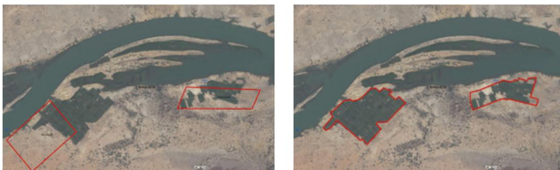
Correction des polygones « on the fly » lors des analyses NDVI. Les polygones améliorés permettent d'automatiser l'analyse NDVI. Le travail sur l'ensemble des environ 400 PIV est immense.
