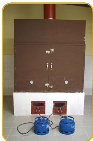
Photo 67 : séchoir à gaz avant remplissage
